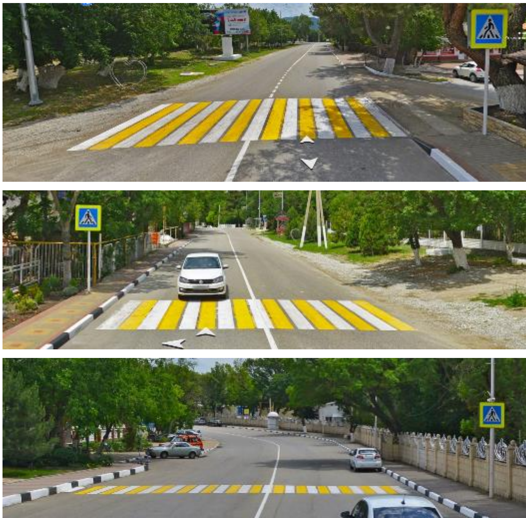
Рисунок 6.5 – Отсутствие дорожного знака 5.19.1(2) на пешеходном переходе по Революционной ул., д. 115, 115Б и 140
