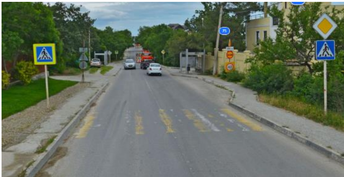
Рисунок 6.3 – Износ горизонтальной дорожной разметки проезжей части по улице Кончаловского.
