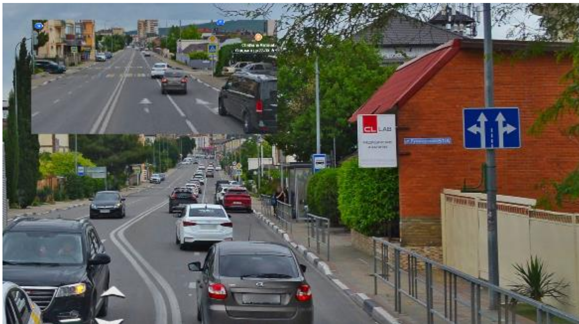
Рисунок 6.8 – Несоответствие (противоречие) требований установки дорожного знака 5.15.1 требованиям горизонтальной дорожной разметки 1.3 и 1.18 по Геленджикскому пр. в направлении пересечения с ул. Тельмана.
